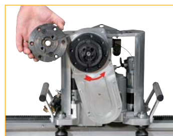
Фланец диска, также подходит для резки вплотную к стене
