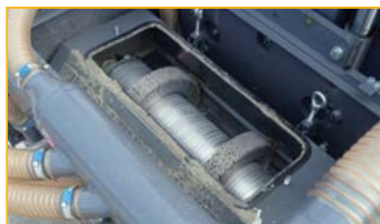
вал, оснащенный дисками для фрезерования
