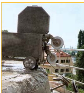
Канатный автомат CSA-1001 при горизонтальной резке
