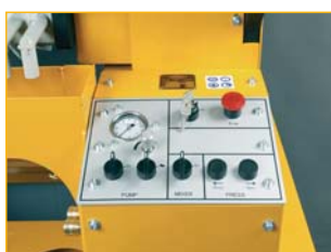
Место оператора (пневматическое управление автоматически выключается при заполнении фильтров)
