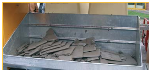
Твердые отходы в емкости для отходов (CBS-1500)
