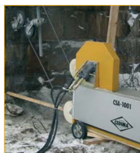
Канатный автомат CSA-1001 при вертикальной резке
