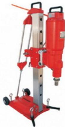
Готовая к работе установка алмазного бурения KS-50 S состоит из позиций 1,2
