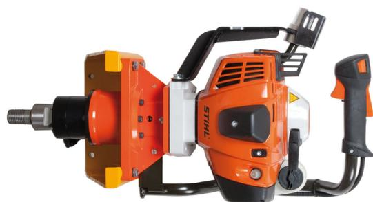
Бензиновый сверлильный двигатель CEDIMA FS-560 (ЦЕДИМА ФС-560) с воздушным охлаждением предназначен для мокрого алмазного сверления отверстий Ø 110 – 400 мм в пустотелом кирпиче, тратуарной плитке, пористом бетоне, поротоне, газосиликатных блоках, кирпичной кладке и других абразивных материалах, а также Ø 110 – 354 мм в бетоне, армированном бетоне и других твердых материалах. Алмазный инструмент используется как керноотборник.
